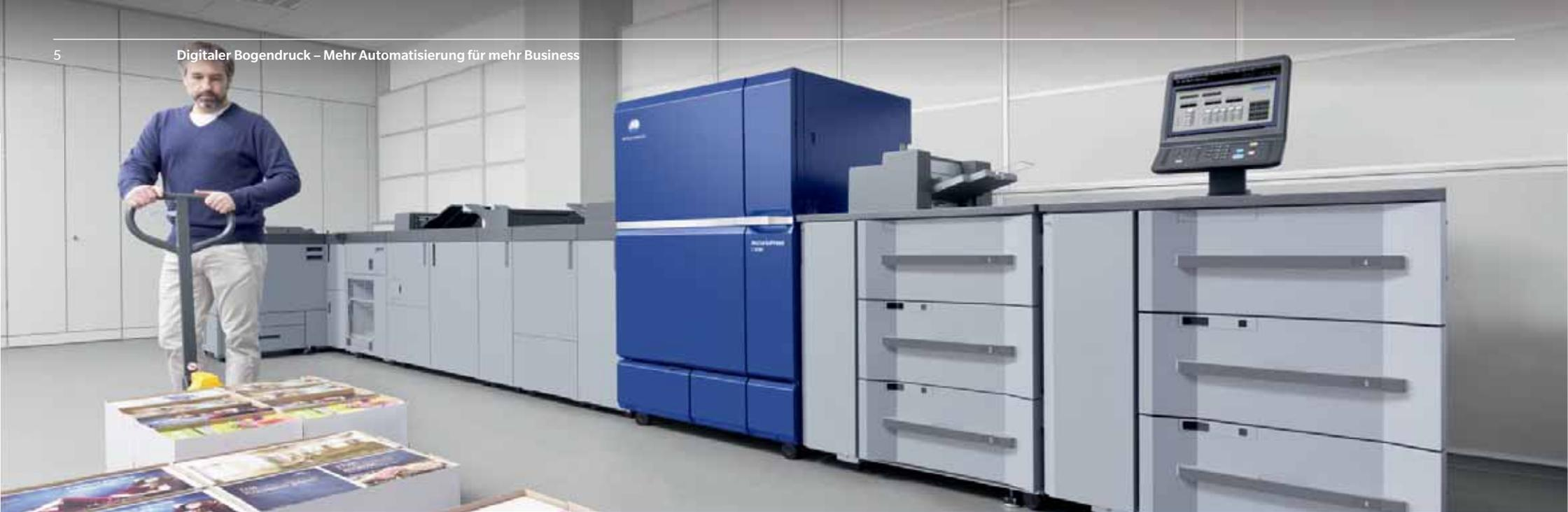
Die Kontrolle und Regulierung der Registerhaltigkeit und der Farbe in Echtzeit über die Erkennung von Druckfehlern bis hin zur automatischen Endverarbeitung in der Inline-Trimmereinheit sind wichtige aber auch zeitraubende Tätigkeiten, die viel Potential für Automatisierung bieten. Das Einmessen und Erkennen von Papiersubstraten, das Auswerfen von Makulaturbogen und die Farbanpassung im laufenden Druckbetrieb sind weitere Aspekte, die enorme Einsparungsmöglichkeiten bieten.
