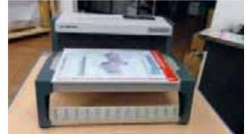
Das elektrische Drahtkammschließgerät Magnopro EC 3400 Plus.
