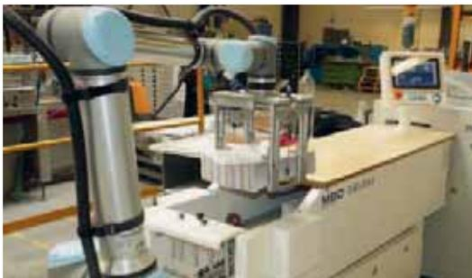
**Produktstapel werden von der Auslage auf den Tisch des CoBo-Stack befördert. Von dort greift der Cobot die Stapel und setzt sie exakt platziert auf Paletten ab.**
