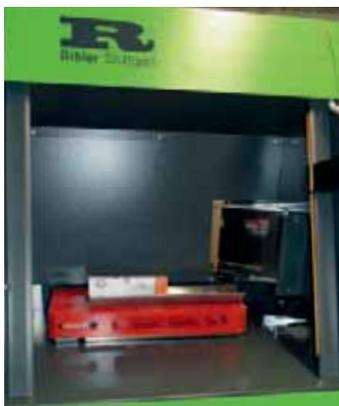
Der Produktionsstart erfolgt durch das einfache Einlegen des Buchblocks in die Zange.
