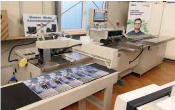
Der Vollautomat Magnopro Bind 580 S für Drahtbindungen leistet bis zu 1.500 Takte/Std. – vom Aufstellkalender bis zum 58 cm breiten Wandkalender.
