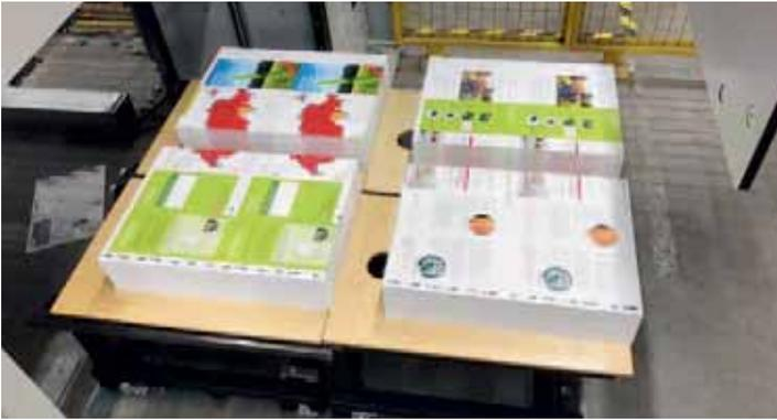
Vier Wagen des Theisen & Bonitz-Vorstapelsystems können magnetisch miteinander fixiert werden und anstatt einer Palette in den Ablader eines Schneidsystems – z.B. Transomat von Polar – gefahren werden. Anschließend dienen sie dem gemeinsamen Transport zur Zusammentragmaschine.
