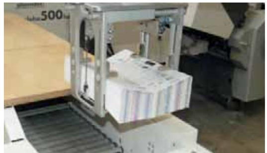
**Durch die Ausrüstung des CoBo-Stack mit jetzt insgesamt drei Greifergößen ist der kollaborierende Roboter von MBO auch in den Formaten sehr flexibel geworden.**
