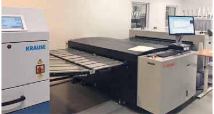
*Herzstück der VLF-Plattenproduktion ist der Cron-Außentrommelbelichter für maximal 1.860 mm Plattenbreite mit integrierter Registerstanzung.*
