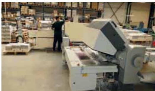
*Eine Falzmaschine wird demnächst zum Arbeitsplatz hin gedreht. Dann kann ein Mitarbeiter dank dem MBO CoBo-Stack von Steuber zwei Falzmaschinen bedienen.*
