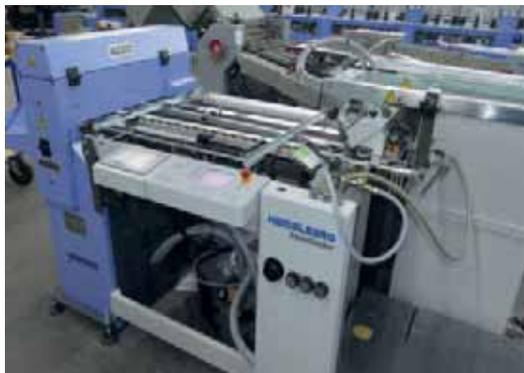
*Über eine üppige Serienausstattung verfügt die neue R50/FSA-Rillmaschine von binderhaus bei YesPrint: Heidelberg-Flachstapelanleger und CCT-Steuerung, Schnittstelle zu Heidelberg-Falzwerken, farbiger Touchscreen u.v.m.*
