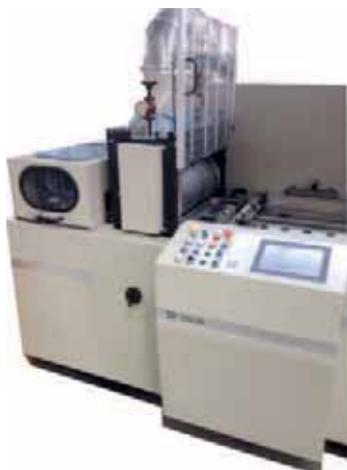
*Die digitale rotative Stanzanlage für Einzelbögen von GEP wird in 22 und 28" Breite gebaut, so dass man den größten Bogenbereich damit abdeckt. Die Anlage kann sowohl mit einem Abroller-Querschneider, der die Einzelbögen von der Rolle schneidet, kombiniert werden – oder mit einem Bogenanleger gespeist.*
