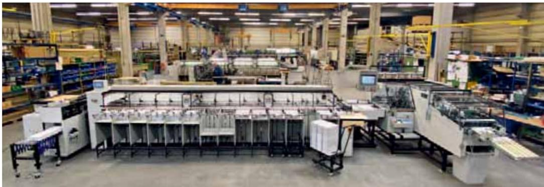
*Eigentlich wurde sie für die drupa gebaut. Da der Messestand nur zehn Meter Breite bot, besitzt sie auch nur 14 statt 16 Stationen. Die tb flex B 314 SP mit kontinuierlicher Stapelauslage (l.), Broschürenfertigung (r.) und einem Vorstapelsystem wird jetzt bestens zu Demozwecken für Kunden im Theisen & Bonitz-Werk in Burscheid eingesetzt.*
