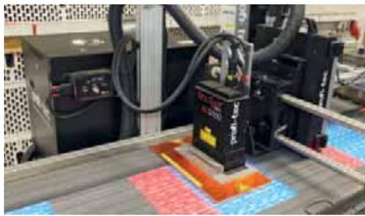
*Das luftgekühlte Hochleistungs-UV-LED-Aushärtungssystem sorgt für sofortige Trocknung.*
